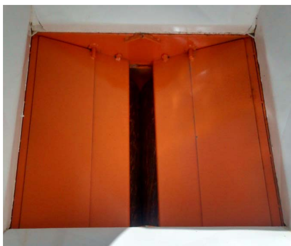
Chapas caídas en posición para el embutidor de Granos Quebrados.
