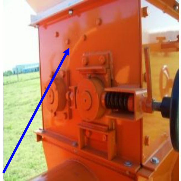
Bulones laterales para apriete de las chapas caídas
