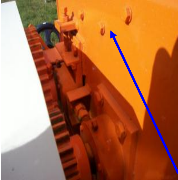
Bulones laterales para apriete de las chapas caídas
